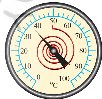
Σχ. 6.1β Θερμόμετρο σε διμεταλλικό έλασμα.
