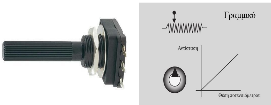
ΕΙΚΟΝΑ 8 ΓΡΑΜΜΙΚΟ ΠΟΤΕΝΣΙΟΜΕΤΡΟ ΚΑΙ Η ΛΕΙΤΟΥΡΓΕΙΑ ΤΟΥ
