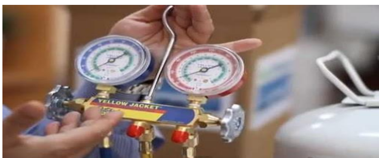
Εικόνα 54 ΑΝΑΛΟΓΙΚΟΙ ΕΝΔΕΙΚΤΕΣ ΑΠΟ ΚΑΣΑ ΜΑΝΟΜΕΤΡΩΝ ΨΥΚΤΙΚΗΣ ΕΓΚΑΤΑΣΤΑΣΗΣ
