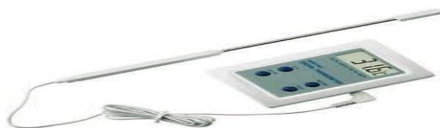
ΗΛΕΚΤΡΟΝΙΚΟ ΘΕΡΜΟΜΕΤΡΟ ΜΕ ΑΙΣΘΗΤΗΡΑ ΕΠΑΦΗΣ ΚΑΙ ΜΕ ΓΕΦΥΡΑ WHEATSTONE
