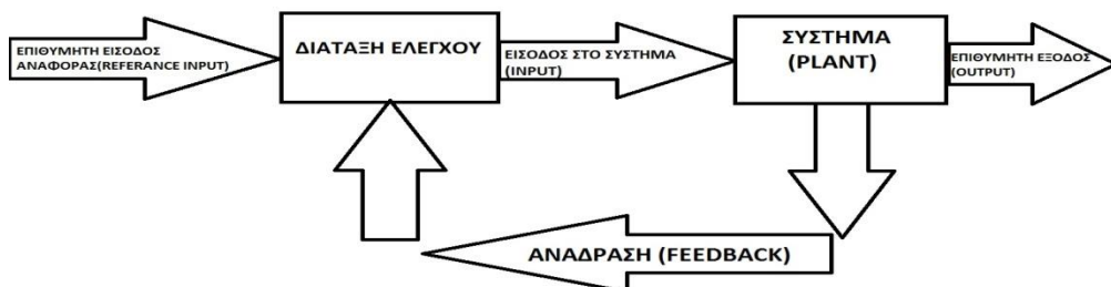
ΣΥΣΤΗΜΑΤΑ ΑΥΤΟΜΑΤΟΥ ΕΛΕΓΧΟΥ ΜΕ ΚΛΕΙΣΤΟ ΒΡΟΓΧΟ ΕΙΚΟΝΑ ΑΠΟ ΤΟΝ ΣΠΟΥΔΑΣΤΗ ΡΗΓΑ ΜΑΡΚΟ ΤΗΣ Α.Ε.Ν. ΑΣΠΡΟΠΥΡΓΟΥ
