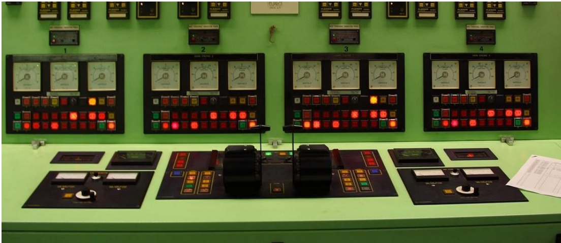
Εικόνα 56 ΣΤΡΟΦΟΜΕΤΡΟ ΑΝΑΛΟΓΙΚΟ ΜΕ ΤΑΧΟΓΕΝΝΗΤΡΙΑ ΓΙΑ ΤΙΣ ΣΤΡΟΦΕΣ ΤΩΝ Μ.Ε.Κ.
