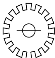
ΣΧΗΜΑ: 3.6.8: Έλασμα του σιδηρομαγνητικού υλικού του δρομέα
