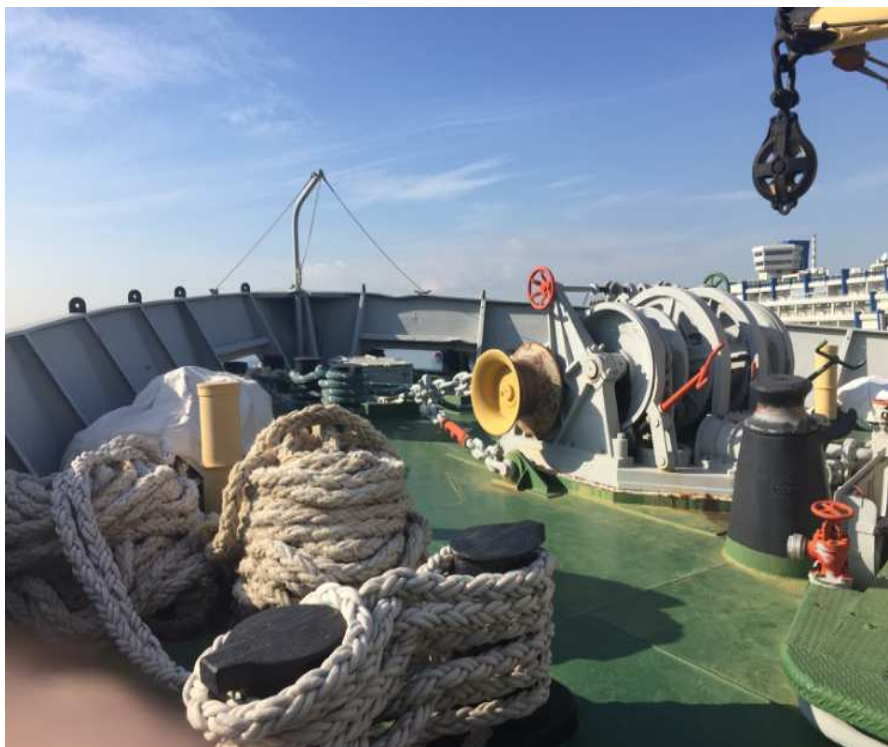
Το δικύλινδρο ατμοκίνητο βαρούλκο άγκυρας (μπόμπα), στην πλώρη του πλοίου
