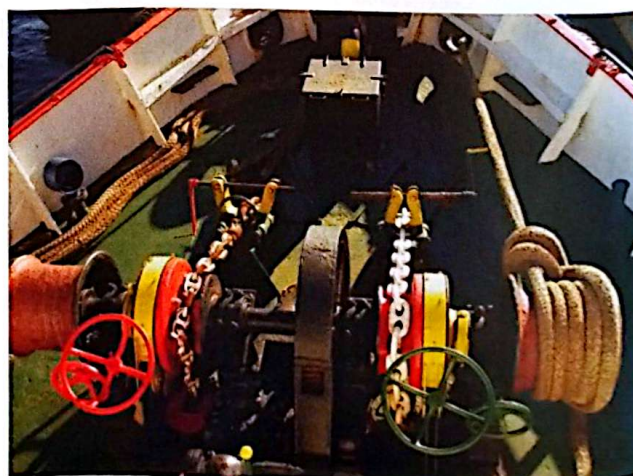
Σχ. 1.16 Υδραυλικό βαρούλκο άγκυρας με τύμπανο πρόσδεσης
