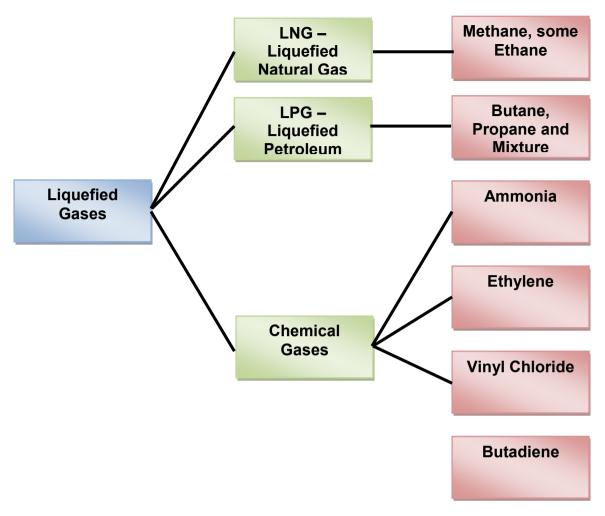
Figure 1.1 (D) TYPES OF LIQUEFIED GASES
