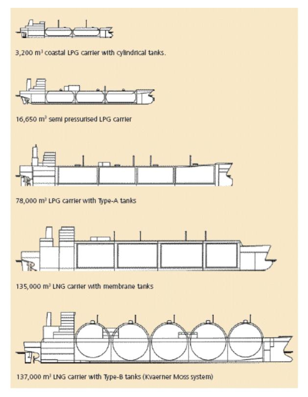
Figure 1.1 (E) TYPES OF GAS TANKERS
