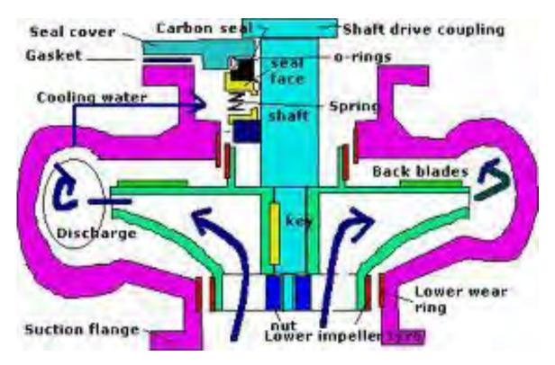
Figure 2.3 (H) CENTRIFUGAL PUMP
