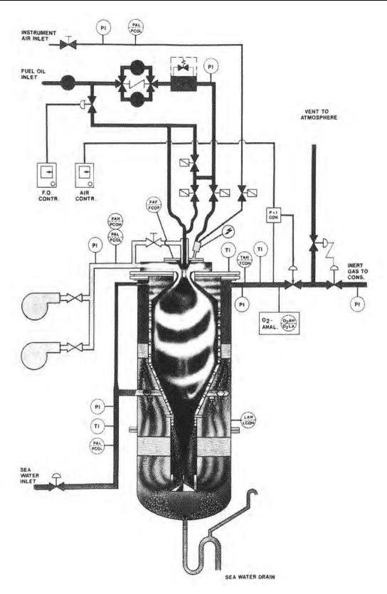
Figure 2.5 (A) AN INERT GAS GENERATOR
