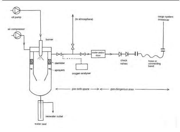
Figure 2.5 (B) SCHEMATIC DIAGRAM OF AN INERT GAS GENERATOR SYSTEM
