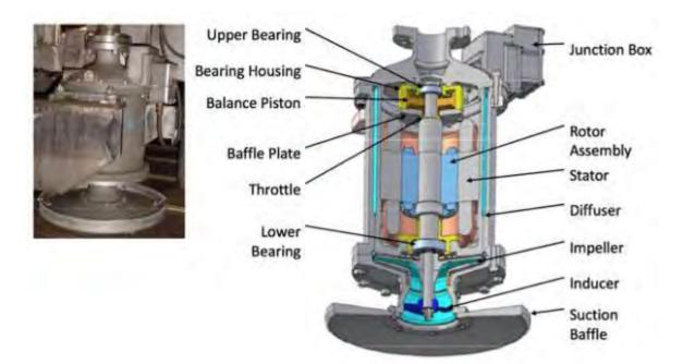
Figure 2.3 (G) SUBMERGED PUMP
