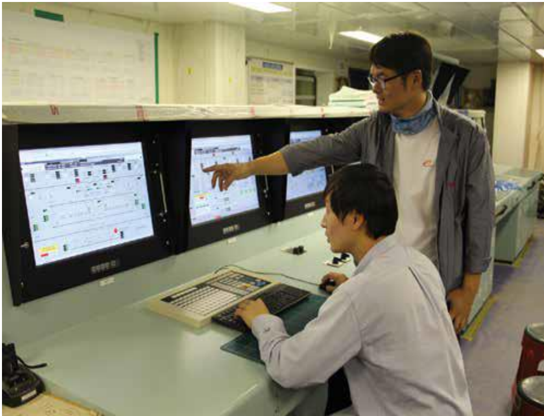
Εικόνα 2.4: Έλεγχος από μακριά βαλβίδων του συστήματος VRCS.
