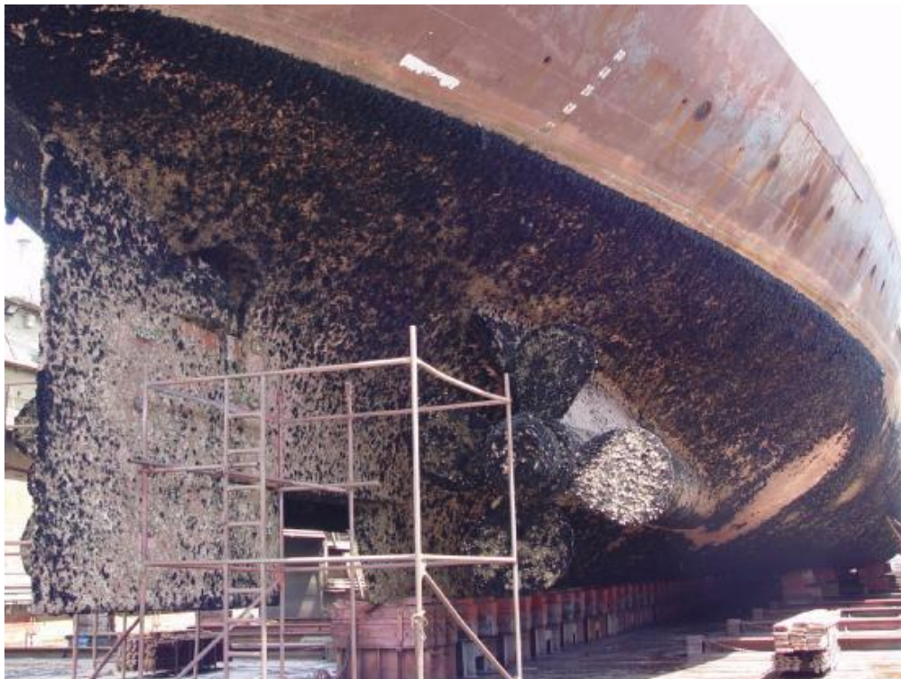
Εικόνα 3: Εκτεταμένη ρύπανση στην γάστρα του πλοίου, την προπέλα και το πηδάλιο [5]
