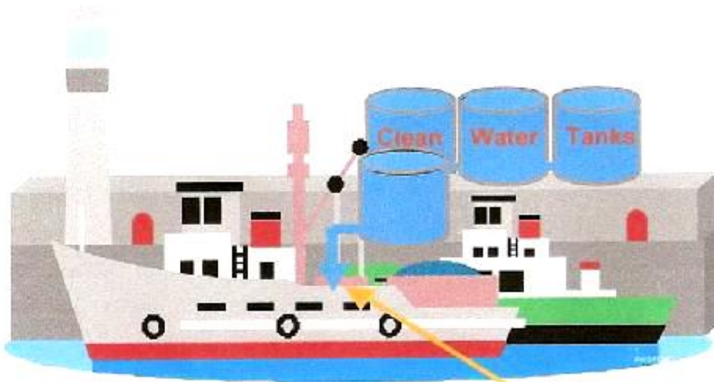
Εικόνα 6: Ερματισμός από εγκαταστάσεις ξηράς [11]
