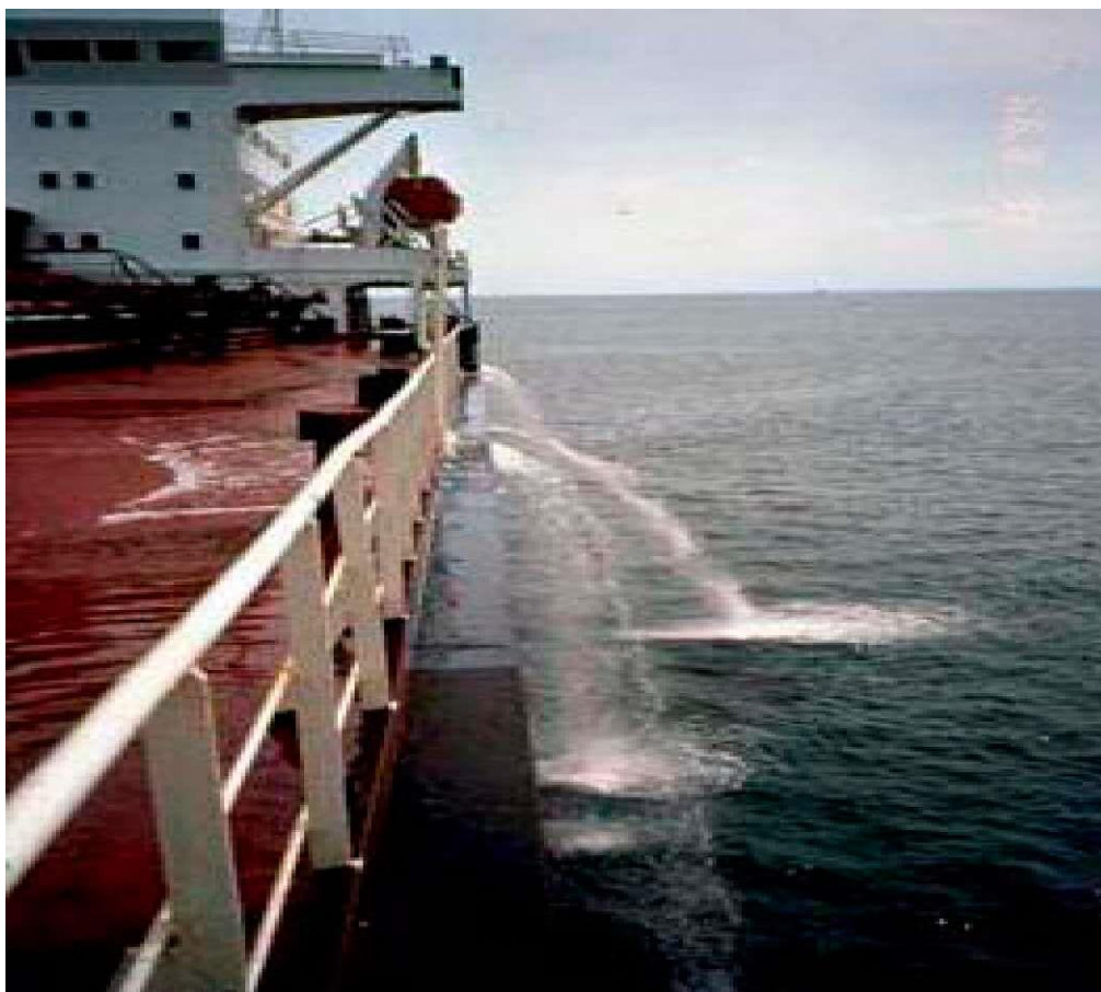
Εικόνα 4: Διαχείριση έρματος στο λιμάνι [7]
