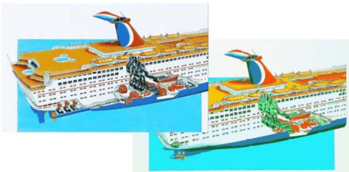
Εικόνα 1.2.β: Το κρουαζιερόπλοιο “M/S Elation” με αζιμουθιακό σύστημα πρόωσης (κάτω δεξιά) και άλλα πλοία που χρησιμοποιούν το ίδιο σύστημα (αριστερά), με σημαντικό ελεύθερο χώρο
