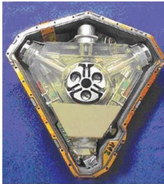
Εικόνα 8: Γυροσκόπιο laser (Παλλήκαρης, Κατσούλης and Δαλακλής, 2016)
