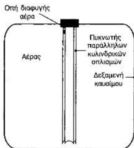
Εικόνα 22: Μέτρηση στάθμης με χρήση χωρητικής βελόνας [9]
