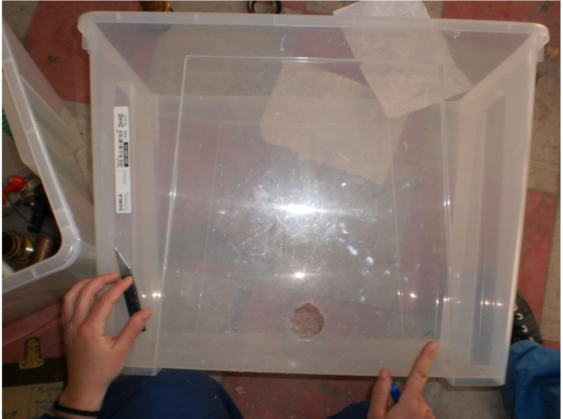
Διάνοιξη οπών για την τοποθέτηση της σωλήνωσης
