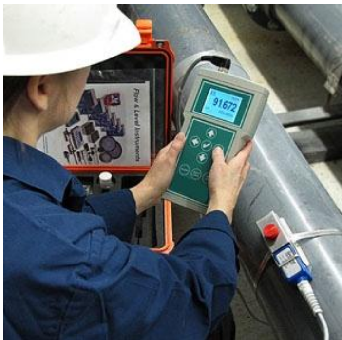
Σχήμα 12. εικόνα μέτρησης με αισθητήρα ροής υπερήχων
