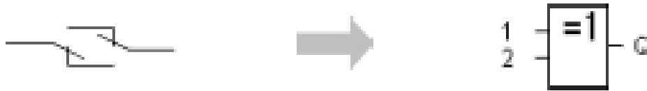
Εικόνα 3.5: Ταυτόχρονη αλλαγή κατάστασης επαφών → Σύμβολο LOGO:
