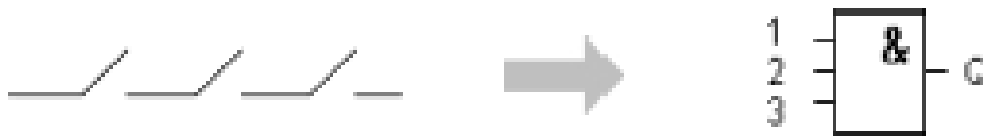
Εικόνα 3.1: Σε σειρά συνδεδεμένες κανονικά ανοικτές επαφές → Σύμβολο LOGO
