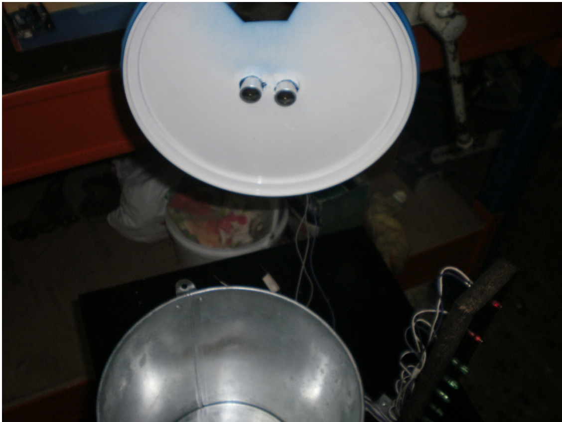
Εικόνα 3.3.4: Τοποθέτηση αισθητήρα στο επάνω μέρος του δοχείου
