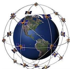
Εικόνα 3.2.9: Ο σχηματισμός των δορυφόρων του GPS.
