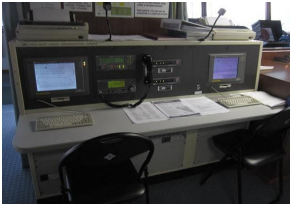
Εικόνα 3.25 :Ο σύγχρονος ασύρματος του πλοίου.
