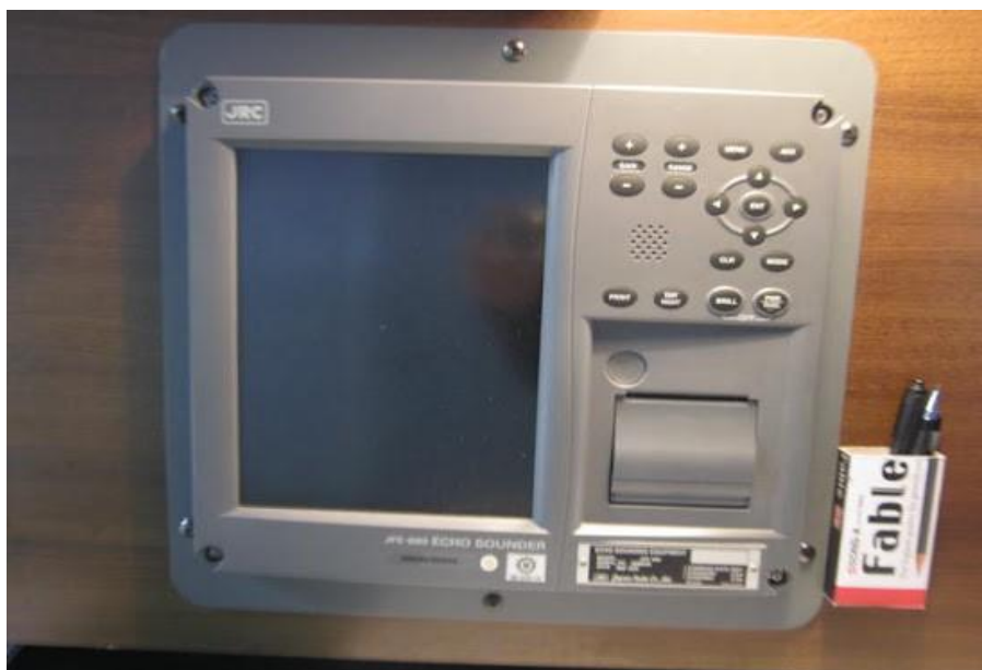
Εικόνα 3.20 :Το βαθύμετρο του πλοίου.
