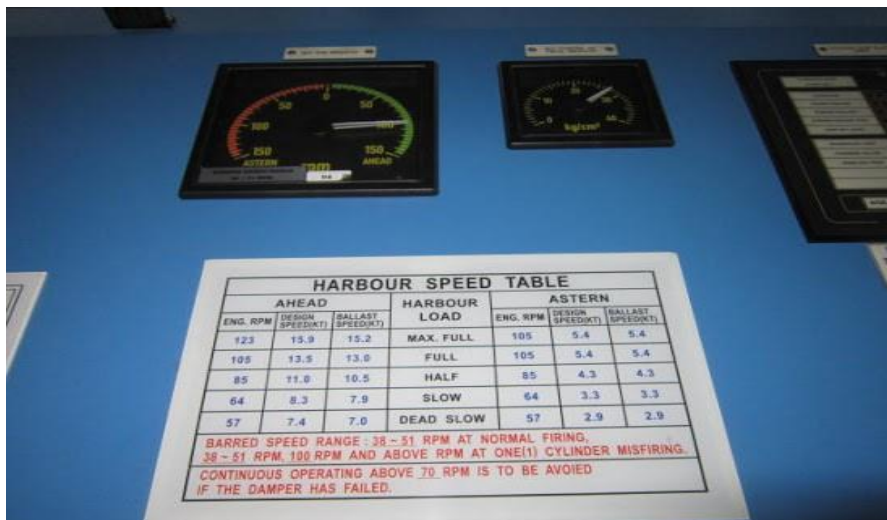
Εικόνα 3.6: Ταμπέλα με στροφές μηχανής και ταχύτητες σε κάθε θέση του τηλεγράφου, κλπ.
