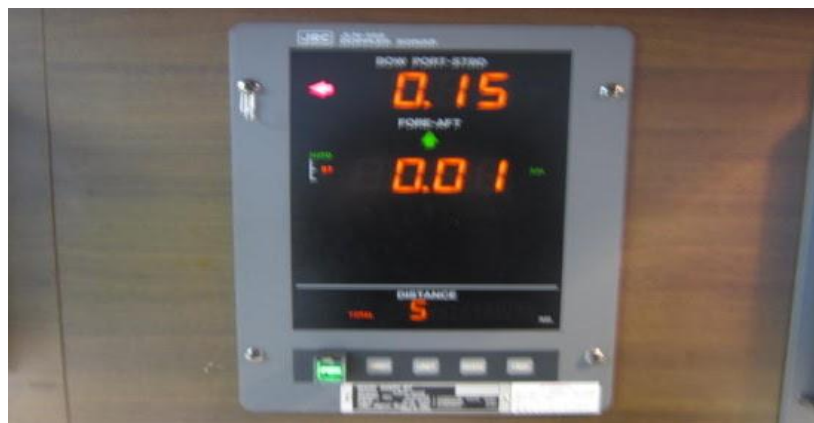
Εικόνα 3.22 :Το δρομόμετρο του πλοίου.
