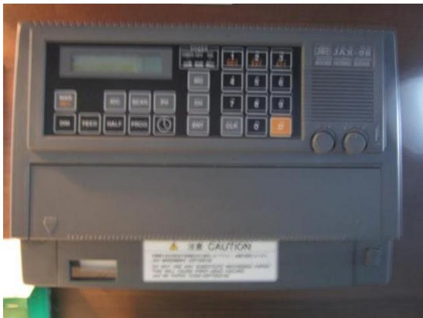
Εικόνα 3.18 :Συσκευή δελτίων καιρού.
