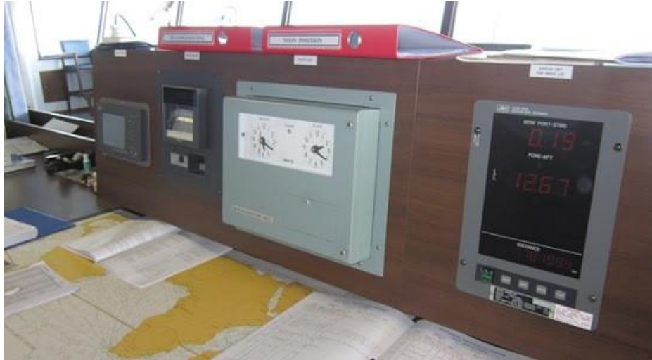
Εικόνα 3.17: Alarm speed log.
