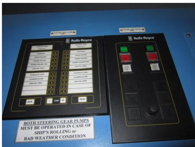
Εικόνα 3.13 :Ο συναγερμός αντλιών τιμονακίου του πλοίου.
