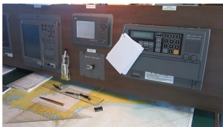
Εικόνα 3.16 :Το GPS του καραβιού.
