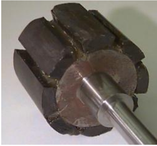
Εικόνα 2.10: Ρότορας με μόνιμους μαγνήτες
