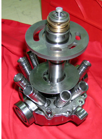
Τα έμβολα τοποθετημένα πάνω στην κεκλιμένη περιστρεφόμενη πλακα
