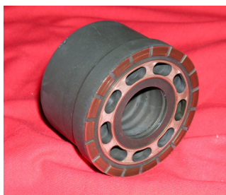
Ο περιστρεφόμενος κύλινδρος στις οπές του οποίου παλινδρομούν τα έμβολα
