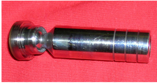
Άλλη όψη από το ίδιο έμβολο όπου διακρίνεται το σφαιρικό άκρο του εμβόλου μέσα στο πέλμα έδρασης
