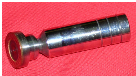
Έμβολο αντλίας υδραυλικού όπου διακρίνεται η σπή στο πέλμα έδρασης απ' όπου "διαρρέει" υδραυλικό υγρό για την υδραυλική εξισορρόπηση
