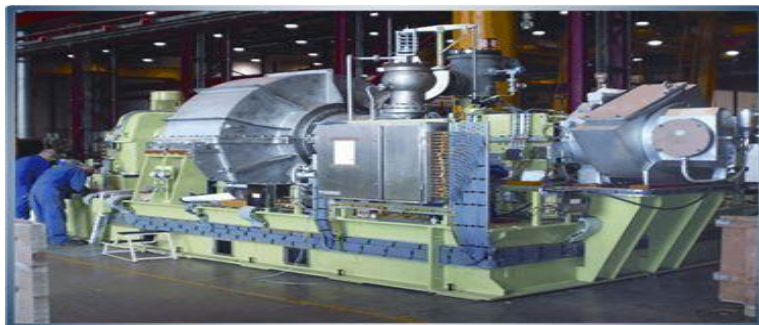
Εικόνα 40 : Στροβιλοκίνητη γεννήτρια παραγωγής ηλεκτρικής ενέργειας
