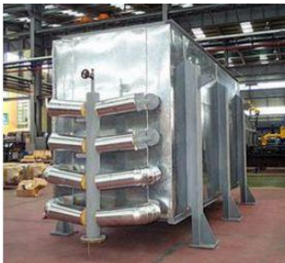
Εικόνα 38 : Προθερμαντήρας καυσιγόνου αέρα με ατμό
