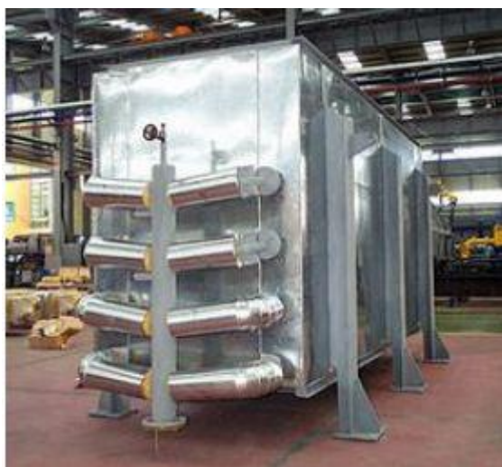
Εικόνα 29 : Προθερμαντήρας καυσιγόνου αερα
