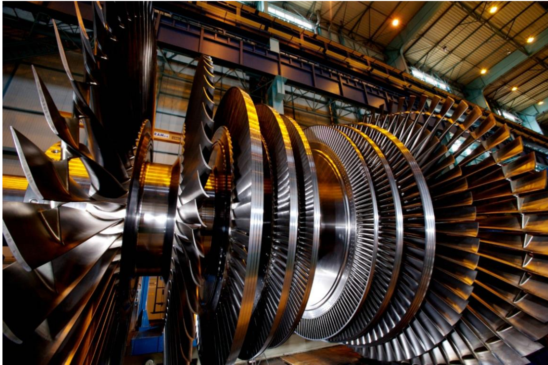
Εικόνα 19 : Ρότορας με τοποθετημένα τα πτερύγια
