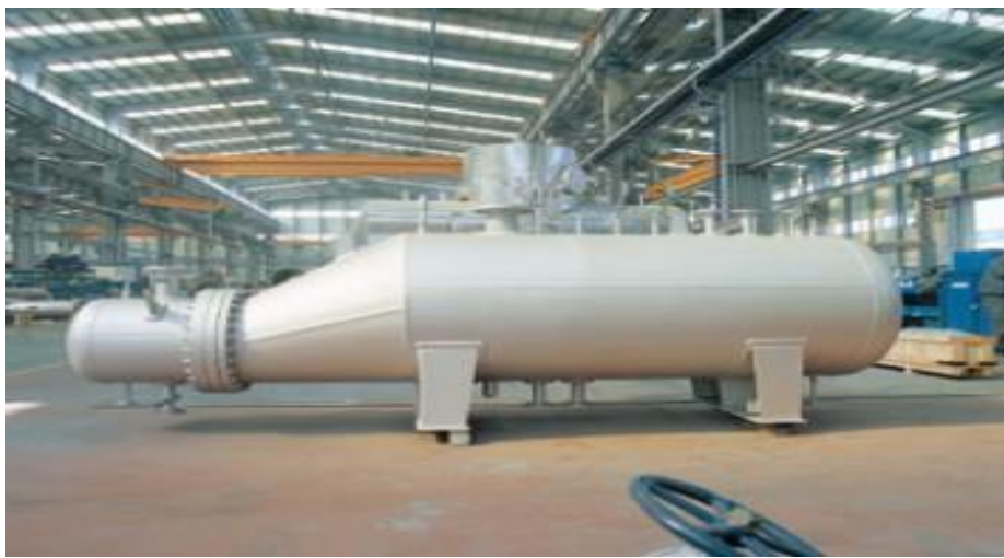
Εικόνα 41 : Λέβητας παραγωγής ατμού χαμηλής πίεσης
