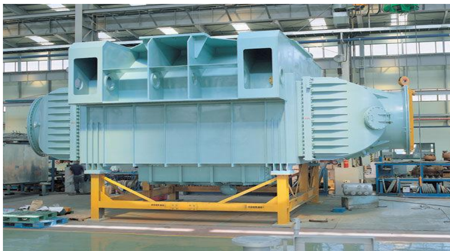
Εικόνα 32 : Κύριο ψυγείο πριν την εγκατάσταση του
