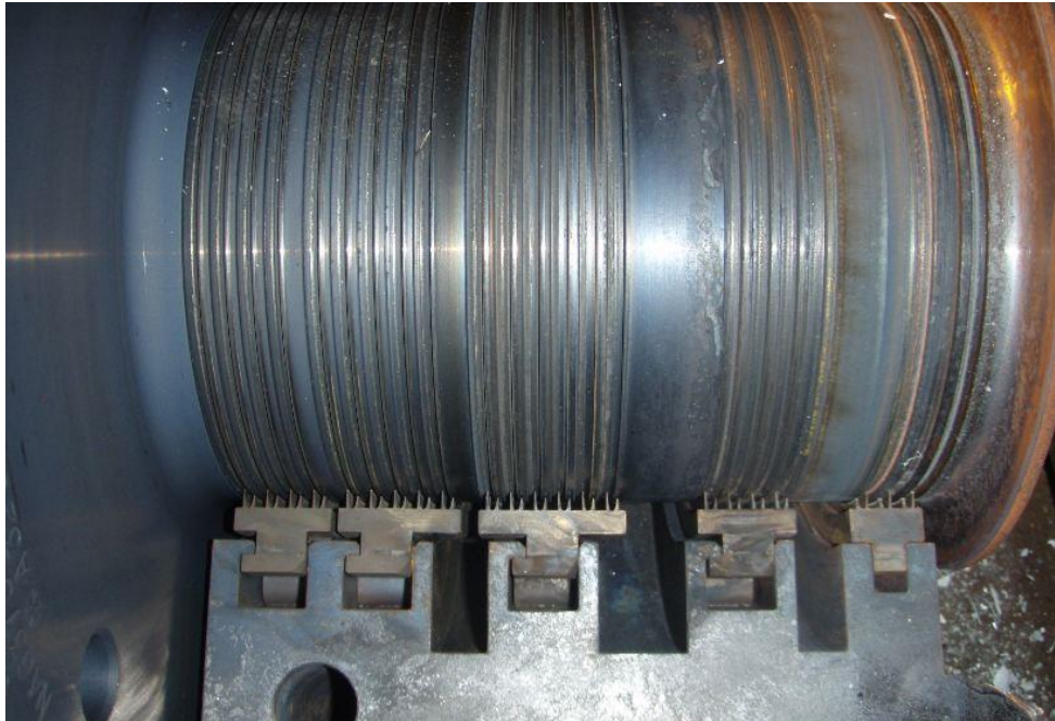
Εικόνα 18 : Το κάτω διάφραγμα των λαβυρίνθων και η διαμόρφωση του άξονα
