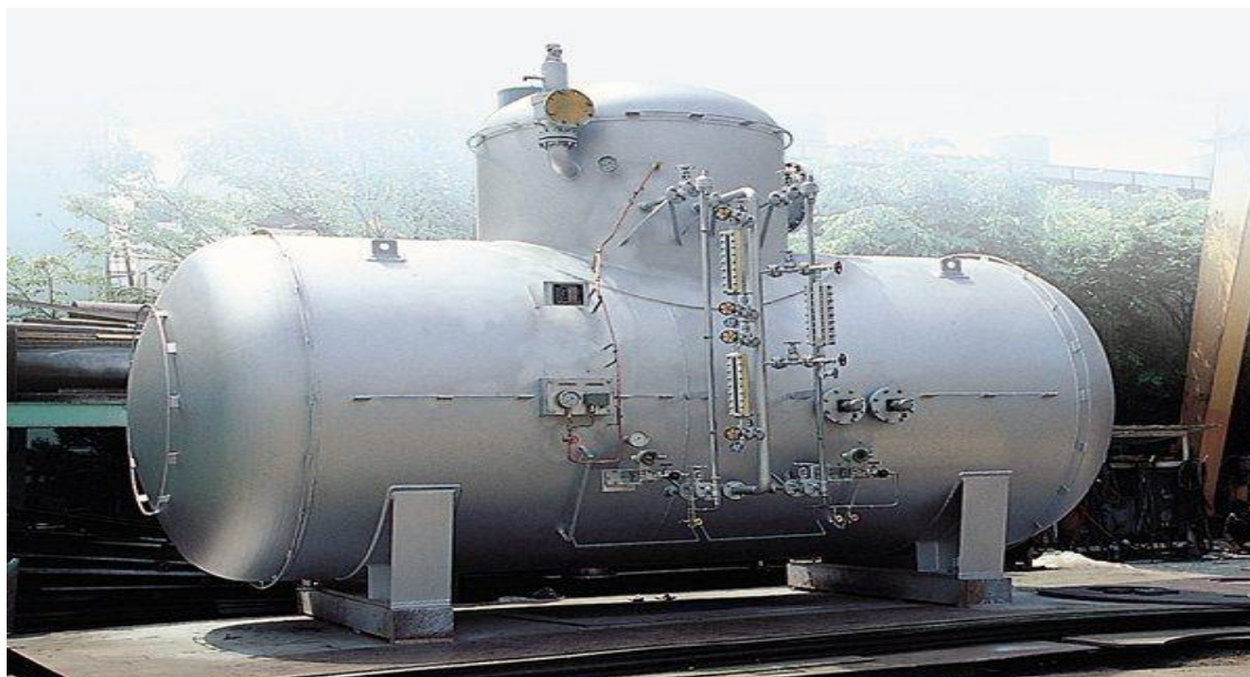
Εικόνα 34 : Εξαεριστική τροφοδοτική δεξαμενή με εξοπλισμό ελέγχου
