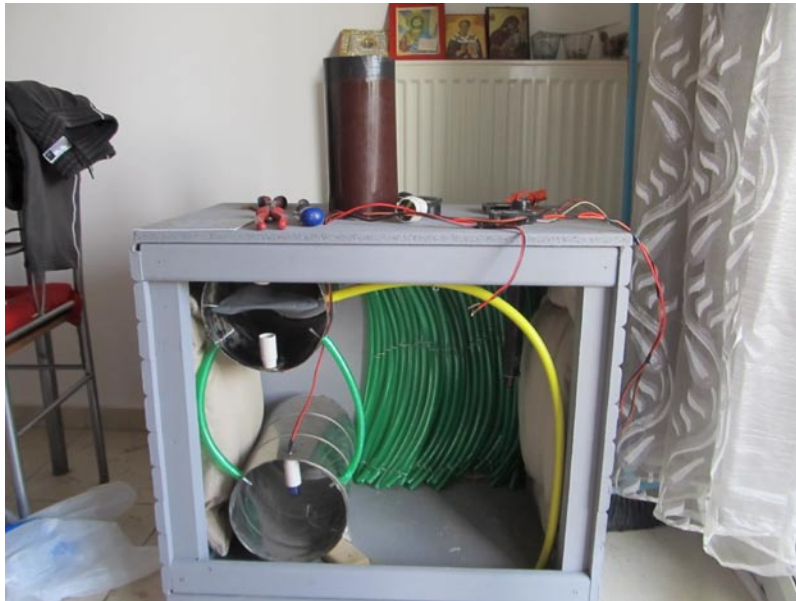
Εικόνα 6.3: Τέλος στην παραπάνω εικόνα βάψαμε το κέλυφος και περάσαμε τους θαλάμους, τις μονώσεις καθώς και τα ηλεκτρικά κομμάτια που θα μας βοηθήσουν στην παρουσίαση και στην καλύτερη κατανόηση της λειτουργίας του λέβητα.
