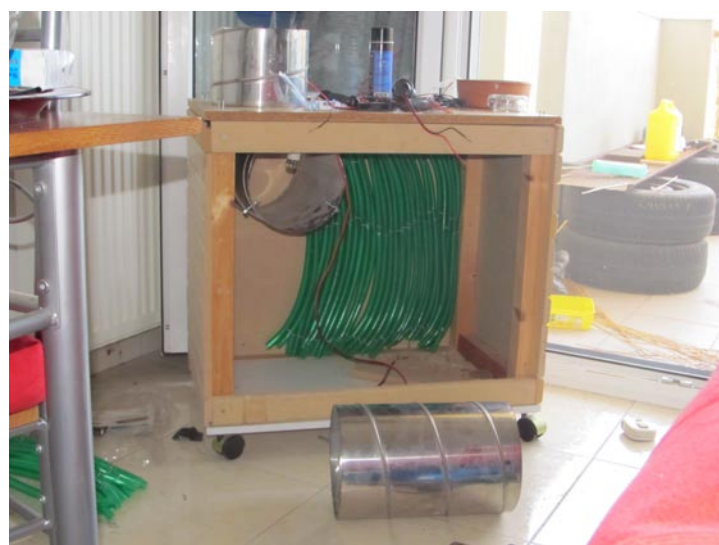
Εικόνα 6.2: Στην παραπάνω εικόνα παρατηρούμε την κατασκευή των υδροτοιχωμάτων, του υδροθαλάμου και του ατμοϋδροθάλαμου
