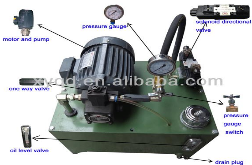
Εικόνα 11) Υδραυλική Μονάδα Ισχύος
