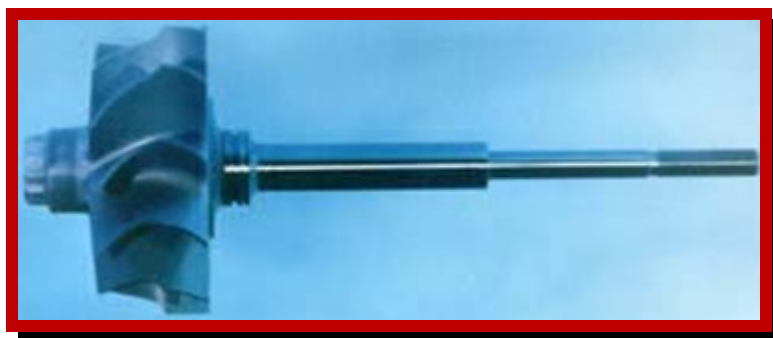
Εικόνα 3.10 Πτερωτή αξονικού στροβίλου κατασκευασμένη από κεραμικό υλικό
