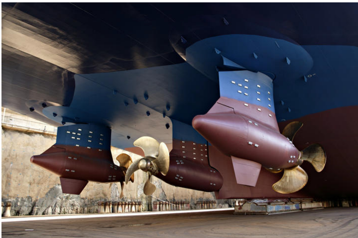
Εικόνα 3. Azipod thruster, ABB Marine [14].
