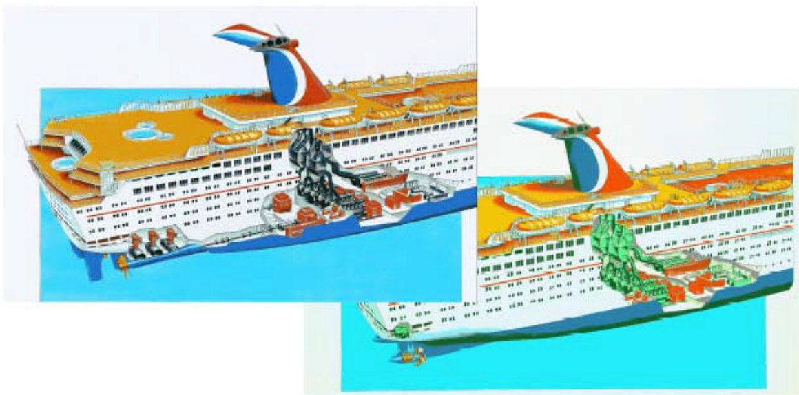
Σχήμα 1. Κρουαζιερόπλοιο “M/S Elation” με azipod (κάτω δεξιά) με σημαντικό ελεύθερο χώρο [1].
