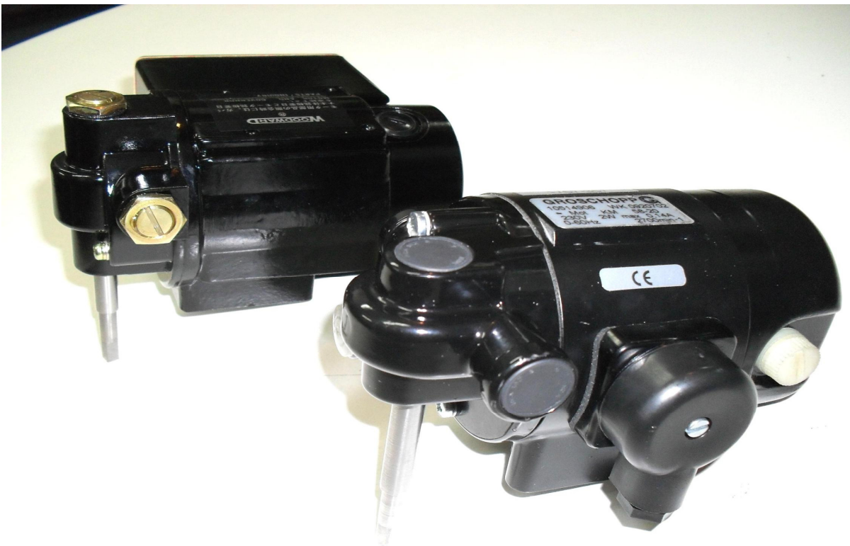
Εικόνα 17 Ηλεκτρικοί κινητήρες για τον καθορισμό επιθυμητών στροφών
