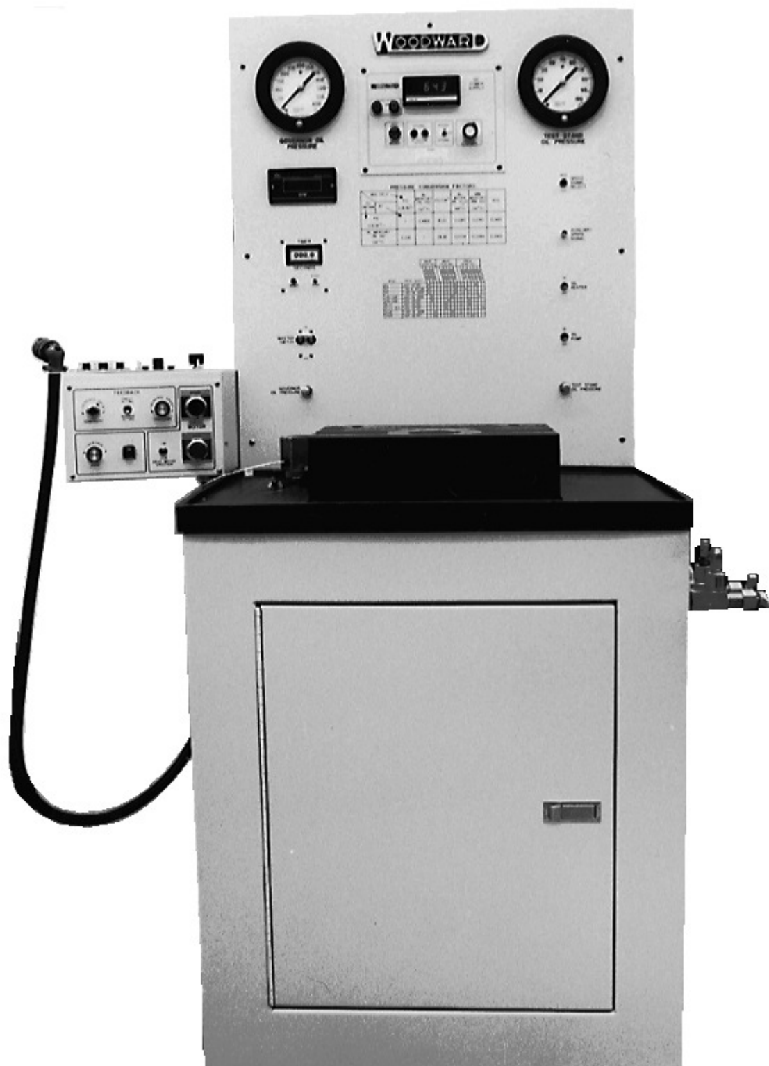
Εικόνα 24 Συσκευή ρυθμίσεως και βαθμονόμησης υδραυλικών ρυθμιστών στροφών (Governor test and calibration device)
