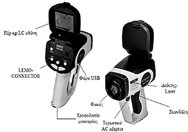
25 Εικόνα: θερμοκάμερα τύπου IVN 780-P, που χρησιμοποιείται για τη θερμογράφιση του πλακοειδούς εναλλάκτη.
