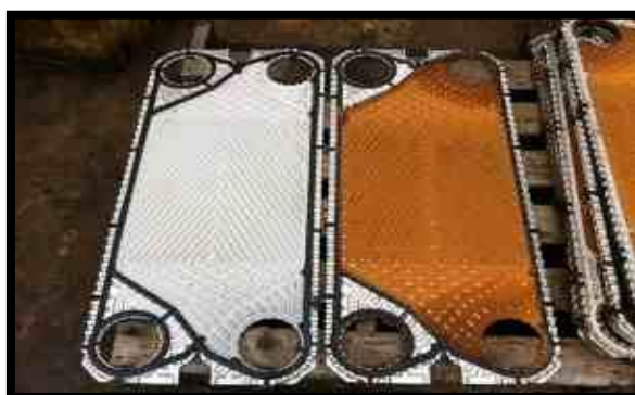
34 Εικόνα 4.5γ : Πλάκα εναλλάκτη πριν τον καθαρισμό ,Πλάκα εναλλάκτη όπου έχουν αφαιρεθεί τοπικά οι επικαθήσεις.
