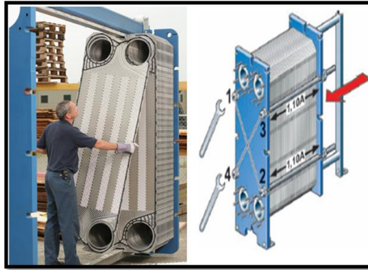
13 Εικόνα 3.3.1α : Εξαγωγή πλάκας από την ράβδο - οδηγό του εναλλάκτη, και σύσφιξη των πλακών.
