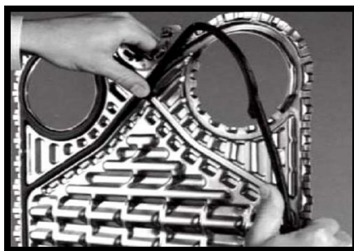
24 Εικόνα 3.6δ: Τοποθέτηση παρεμβύσματος σε μία πλάκα του εναλλάκτη.
