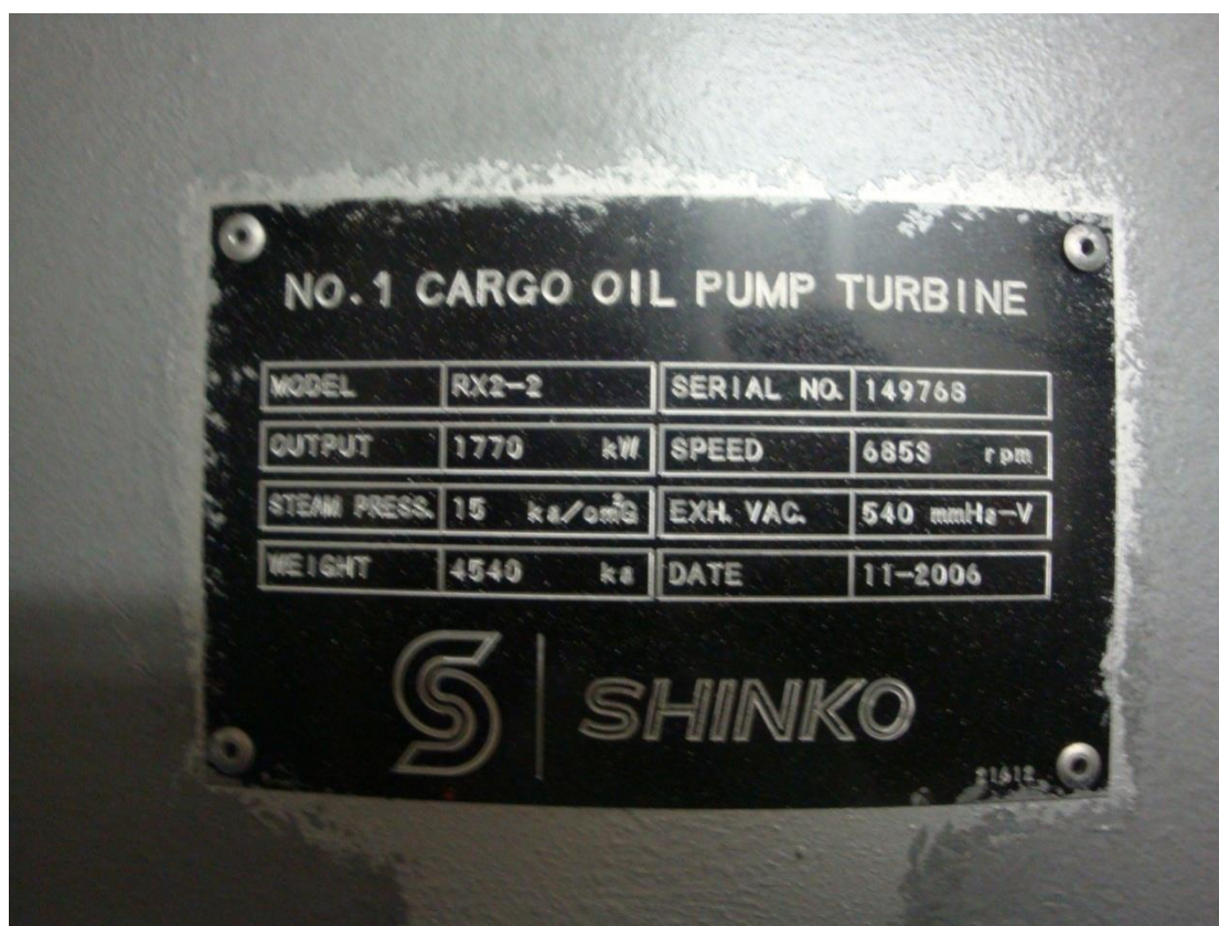
Εικόνα 5: Χαρακτηριστικά ατμοκίνητης αντλίας φορτίου SHINKO.
