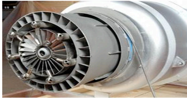
Εικόνα 6: Καυστήρας Φυσικού Αερίου Λέβητα
