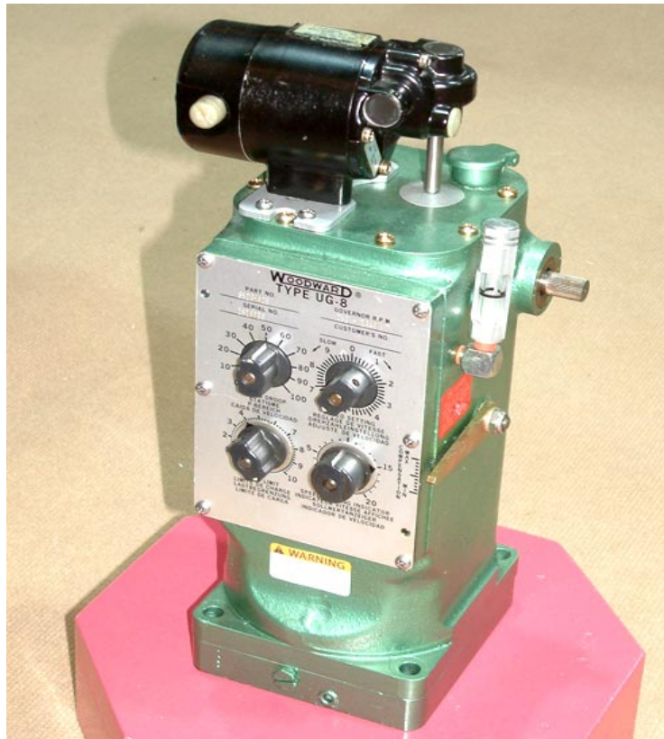
Εικόνα 5.4 Εικόνα από Μηχανικό-υδραυλικό σύστημα ελέγχου στροφών τύπου Governor UG-8. Οι ρυθμίσεις γίνονται μέσω περιστρεφόμενων Διακοπών.
