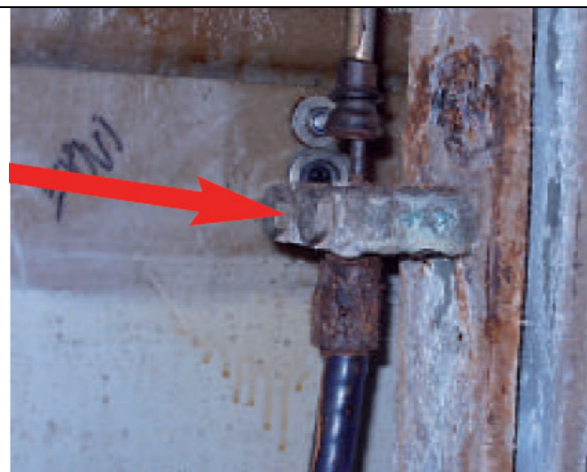
Εικόνα1-9:Μια πιο προσεκτική ματιά στο καλώδιο πρυμναίου αριστερού άγκιστρου, προτασία καλωδίου σκουριασμένη και σπασμένη
