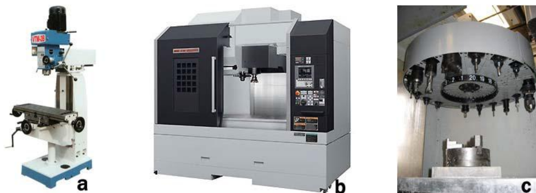
Σχήμα 1.4 (a) Σύγχρονο χειροκίνητο δρόπανο, (b) Κάθετο κέντρο κατεργασίας CNC, (c) Αυτόματος τροφοδότης κοπτικών εργαλείων.
