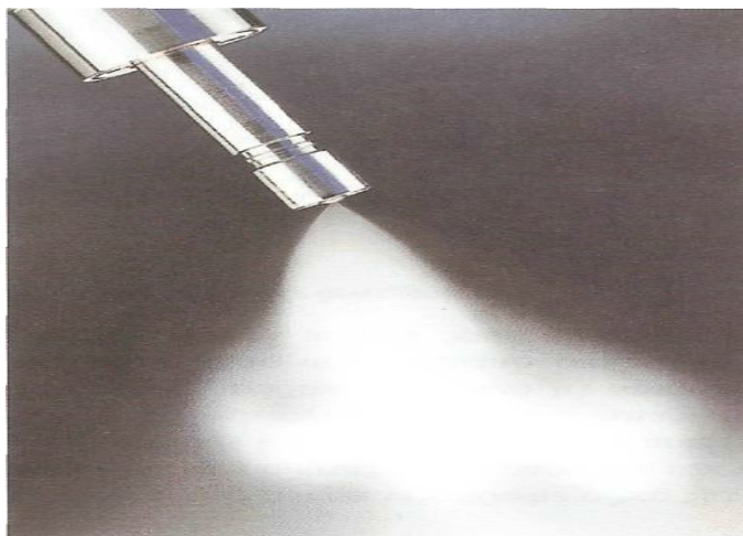
Εικόνα 4: Σχηματισμός νέφους καυσίμου κατά την έγχυση
