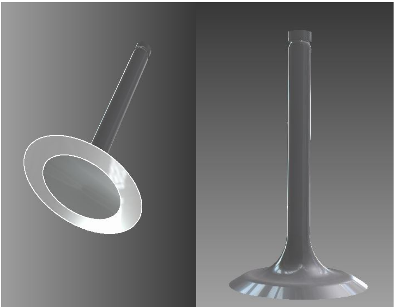
Εικόνα 3.4: Τρισδιάστατος Σχεδιασμός βαλβίδας εξαγωγής κινητήρα. Τελική μορφή
