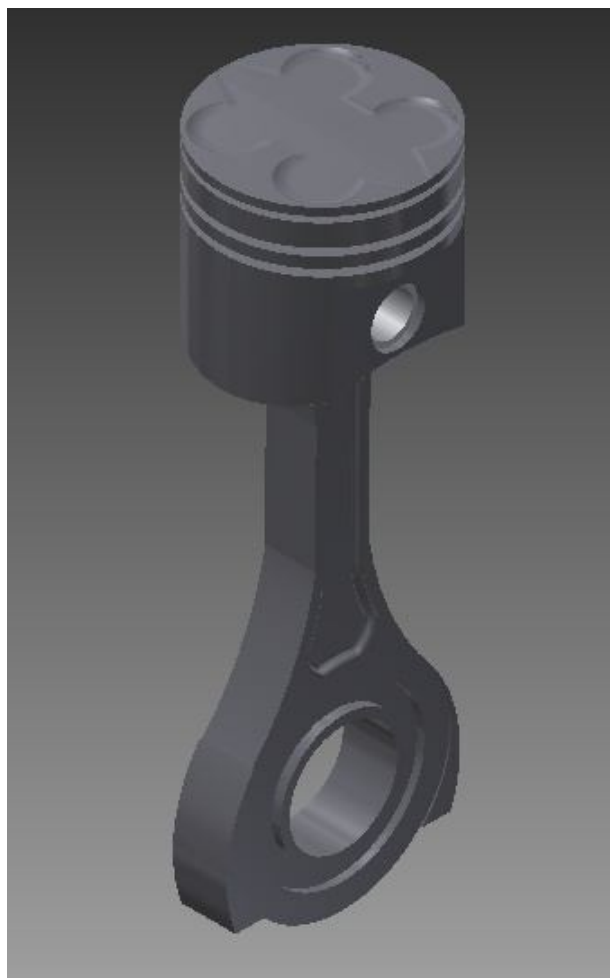
Εικόνα 4.8: Τελική συναρμολόγηση συστήματος διωστήρα
