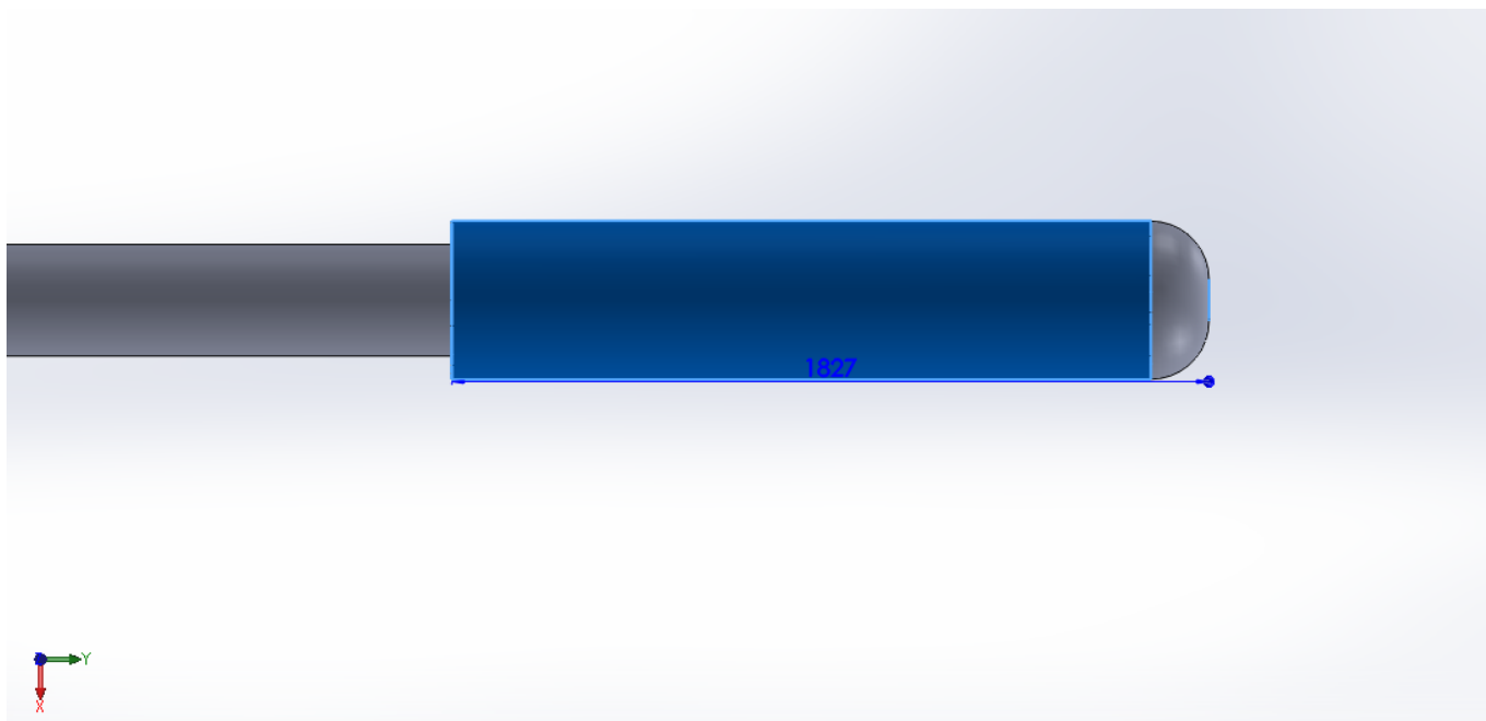
Εικόνα 4.6.9 : Δημιουργία δεύτερου εξωτερικού περιβλήματος με την χρήση εντολής MIRROR
