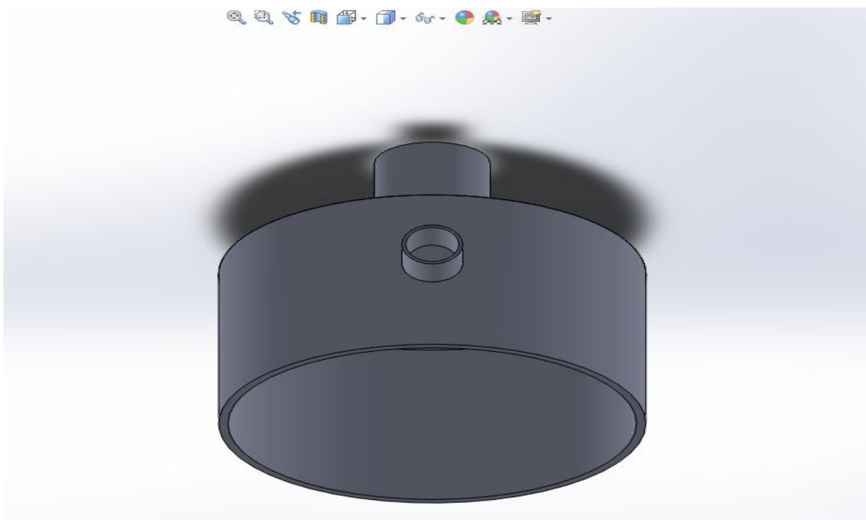
Εικόνα 2.2.12 : Δημιουργία της πάνω σωλήνας με την εντολή BOSS-EXTRUDE
