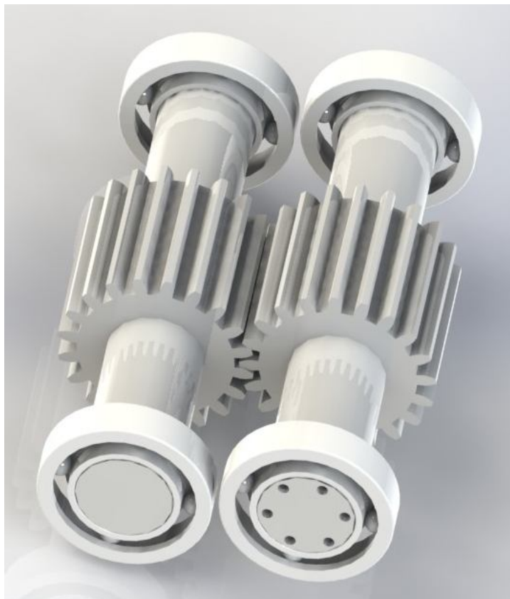
ΕΙΚΟΝΑ Π.52 : Κάτοψη γραναζιών με ρουλεμάν
