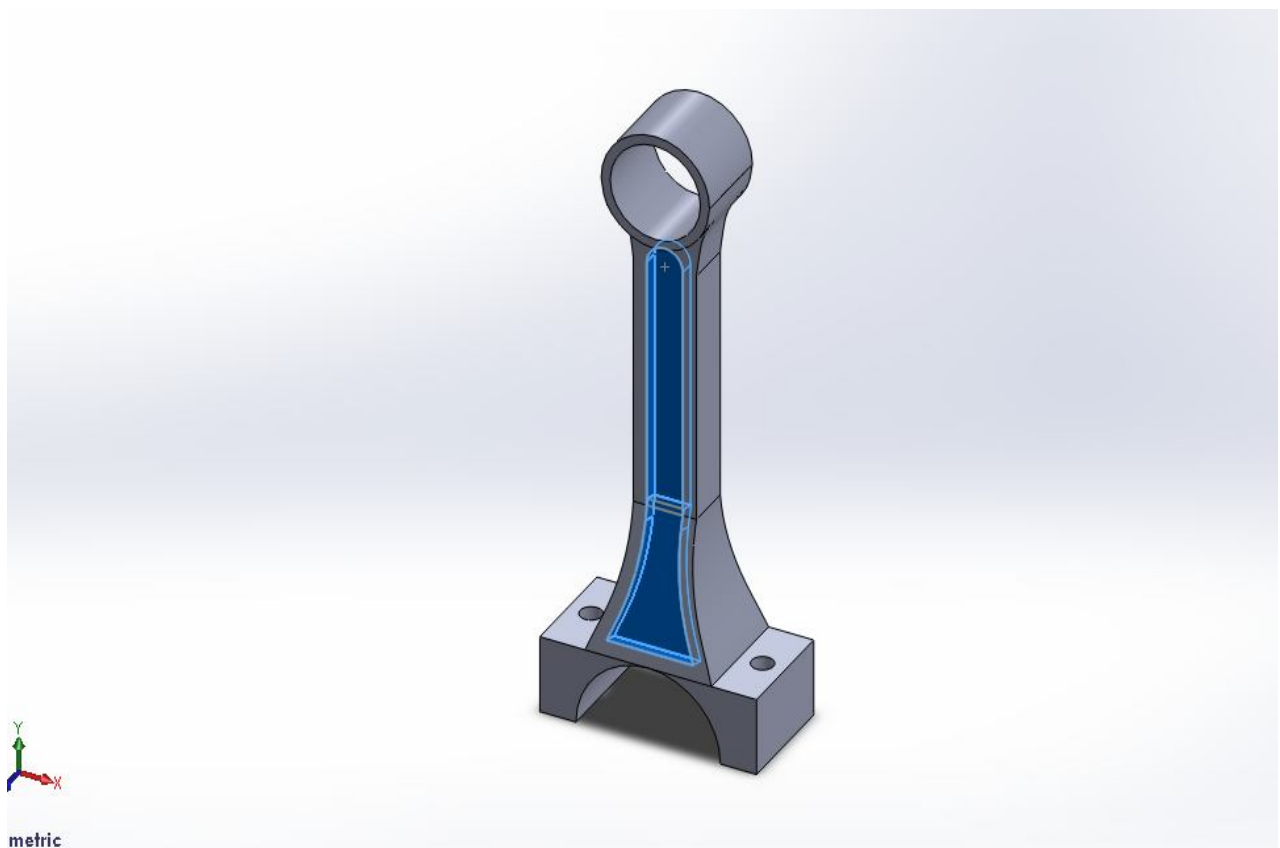
Εικόνα 3.27: Αφαίρεση υλικού από το μοντέλο
