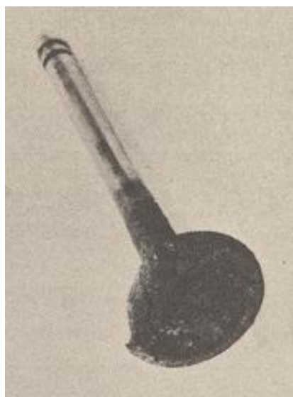
Σχήμα 2.4.3 (β) : Καμένη βαλβίδα εξαγωγής
