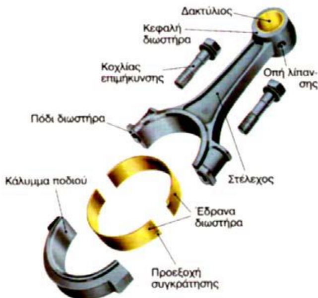
Σχήμα 2.3.1. : Διωστήρας
