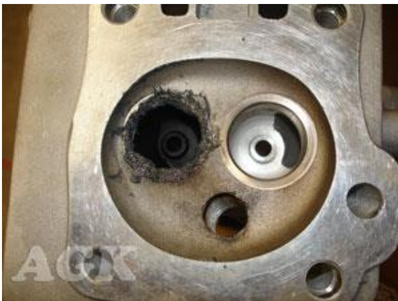
Σχήμα 2.4.3 (α) : Καμένη έδρα βαλβίδας
