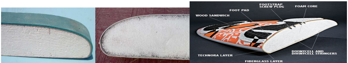
[Εικόνα 50] Χαρακτηριστικές μορφές τομών sandwich σανίδων
