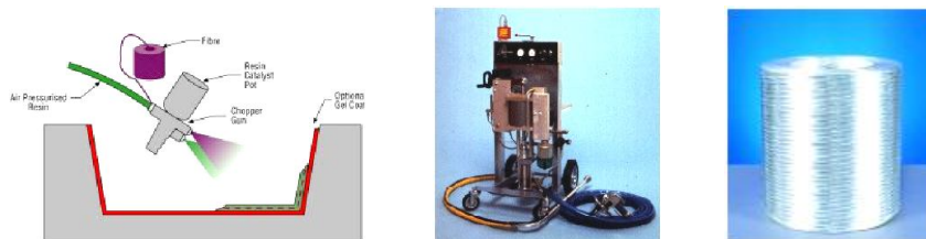
[Εικόνα 51] Μηχανισμός spray – up με μηχανή ψεκασμού και πλεξίδα νημάτων
