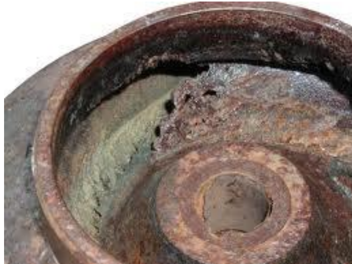
Εικόνα 16. Δημιουργία σπηλαιώσης στο κέλυφος αντλίας.
