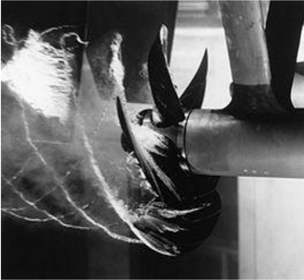
Εικόνα 18. Cavitating propeller model in a water tunnel experiment.
