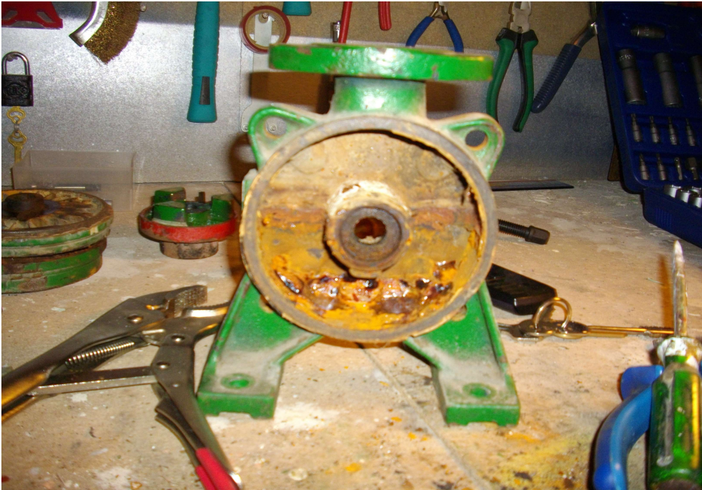
Εικόνα 9: Πλευρά της αντλίας που έρχεται σε επαφή με το νερό
