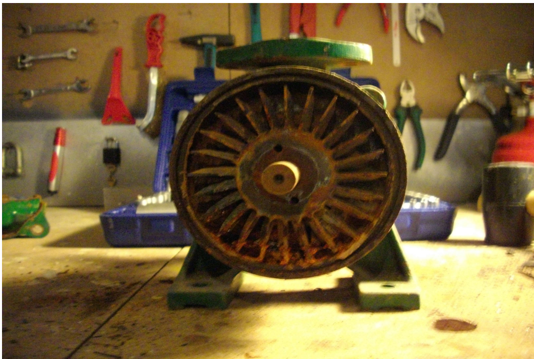
Εικόνα 4: Διάβρωση στην περωτή
