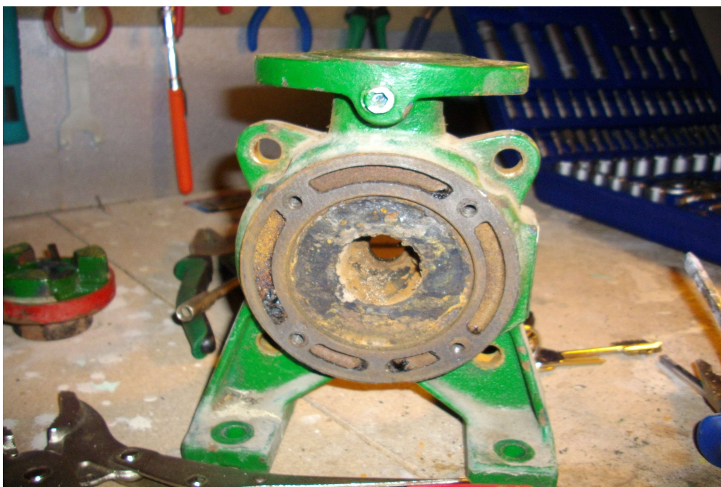
Εικόνα 10: Πλευρά της αντλίας που δεν έρχεται σε επαφή με το νερό
