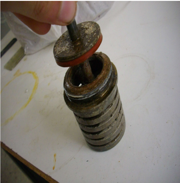
Εικόνα 27: Ανεπίστροφη βαλβίδα στο σωλήνα αναρροφήσεως
