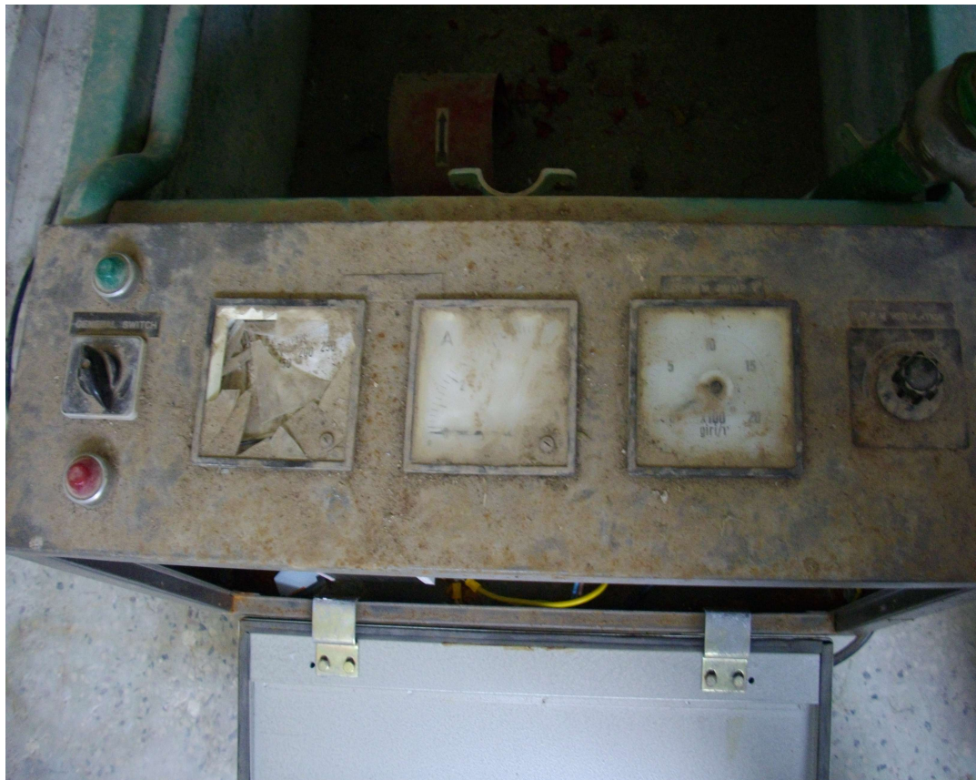
Εικόνα 2: Σπασμένο τζαμάκι στο βολτόμετρο
