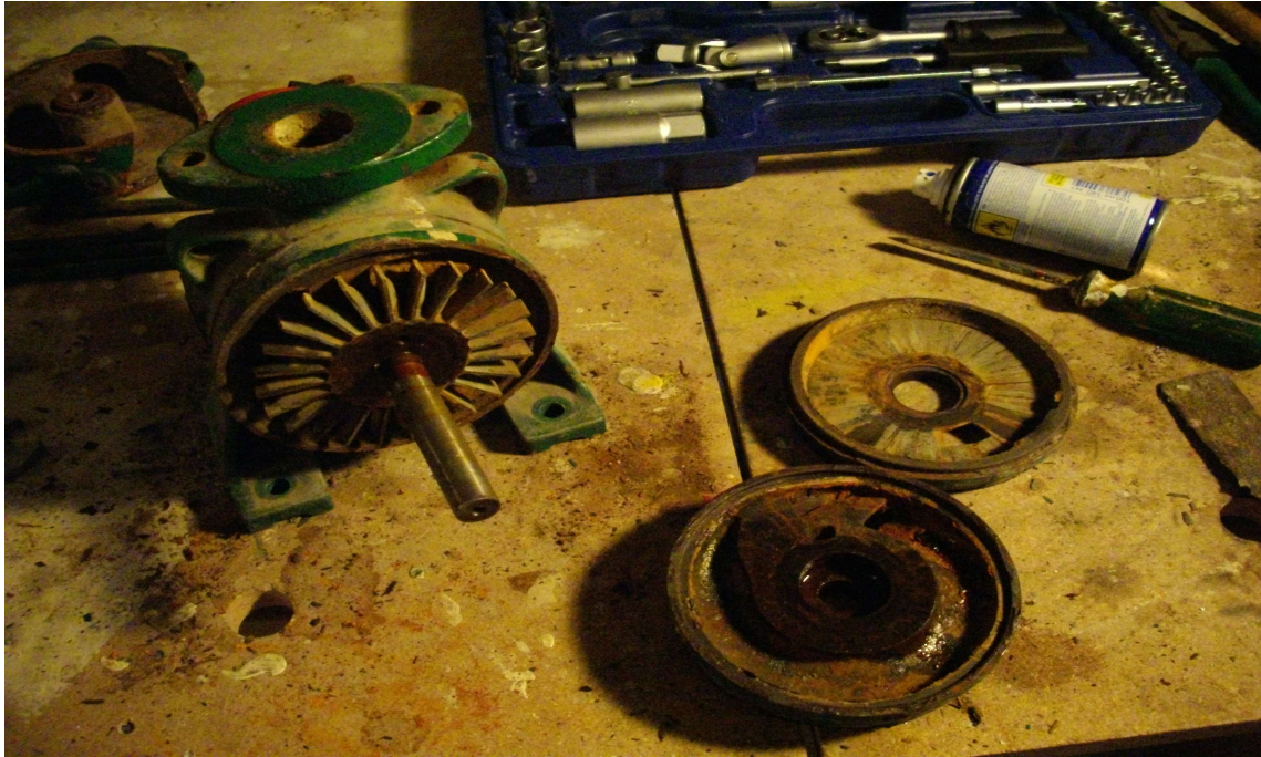
Εικόνα 7: Διαβρωμένο κέλυφος και περωτή στο δεύτερο στάδιο
