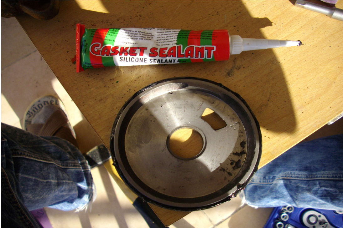
Εικόνα 19: Σιλικονούχα φλατζόκολλα για στεγανοποίηση
