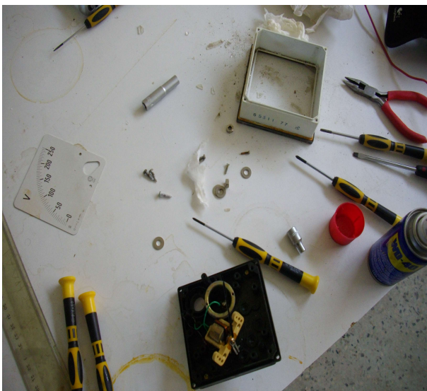
Εικόνα 28: Επισκευή και ρύθμιση βολτόμετρου
