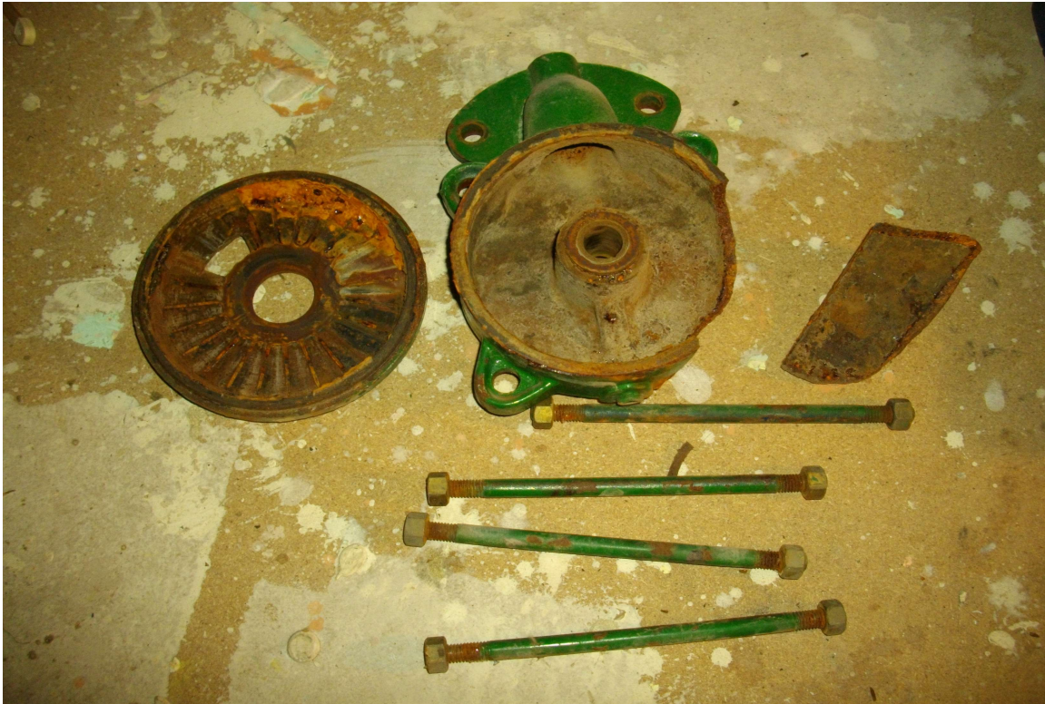
Εικόνα 5: Διάβρωση στα κομμάτια από το κέλυφος
