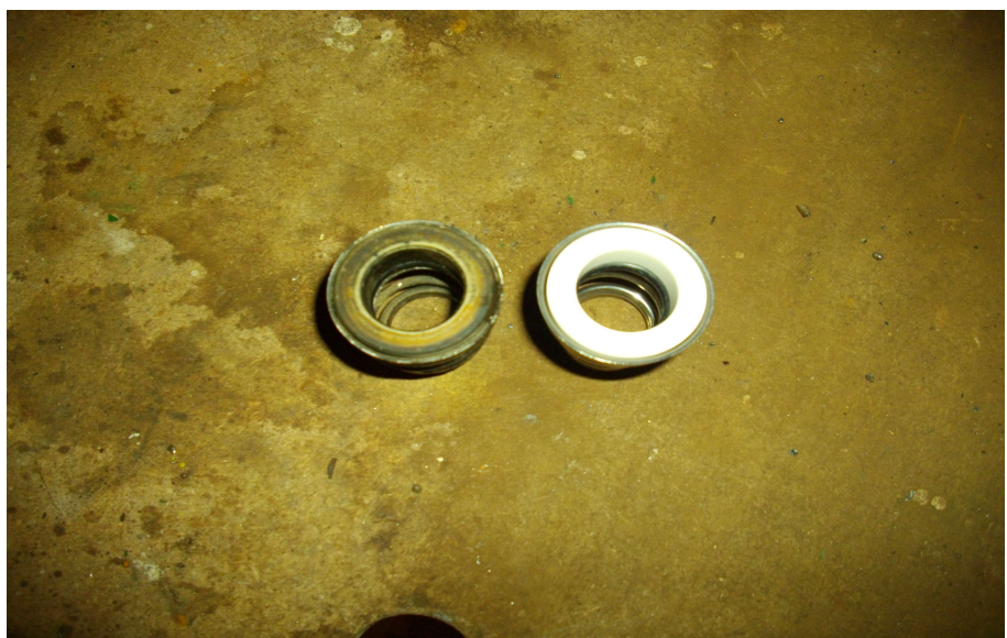
Εικόνα 14: Καινούριο στεγανοποιητικό (δεξιά)
