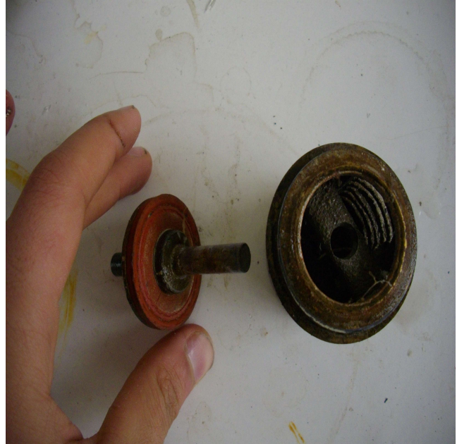
Εικόνα 26: Ανεπίστροφη βαλβίδα στο σωλήνα αναρροφήσεως
