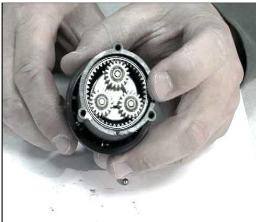
εικόνα X: εσωτερική διάταξη των πλανητών και του φορέα σε σύνθετο πλανητικό τύπου Wolfram
