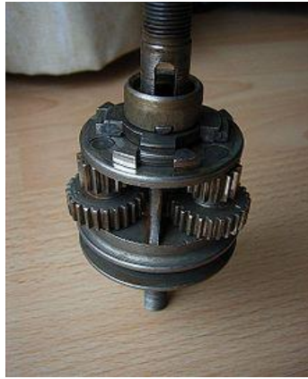
εικόνα X: εσωτερική διάταξη των πλανητών και του φορέα σε σύνθετο πλανητικό τύπου Wolfram
