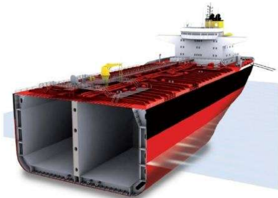
Εικόνα 11. Τομή Δεξαμενόπλοιου Διπλών Τοιχωμάτων (Double Hull Tanker-DHT). Πηγή: http://www.schleswig-holstein.de
