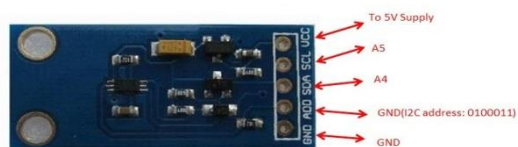
Εικόνα 22: Αισθητήρας μέτρησης φωτός BH - 1750FVI
