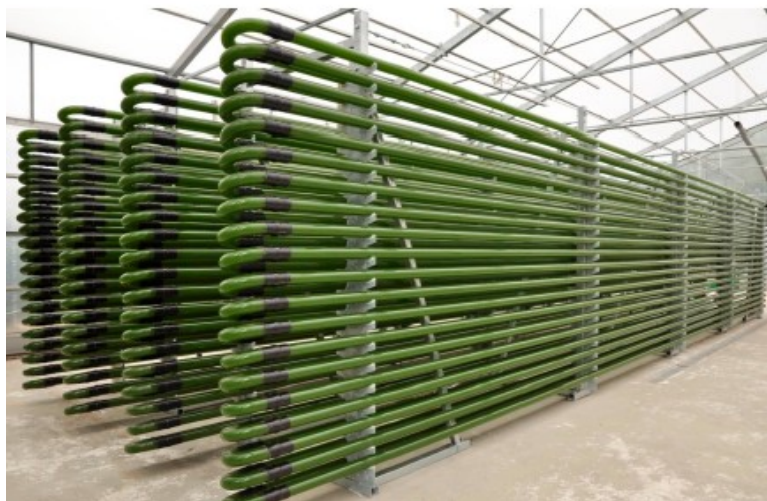
Σχήμα 5.2. Αυλωτοί φωτοβιοαντιδραστήρες (Johnson και Wen, 2009).
