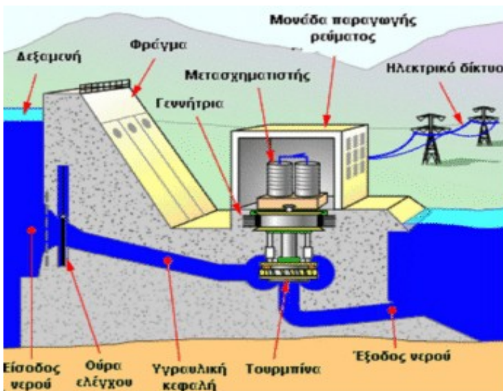
Εικόνα 9: Λειτουργία ενός Υδροηλεκτρικού σταθμού
