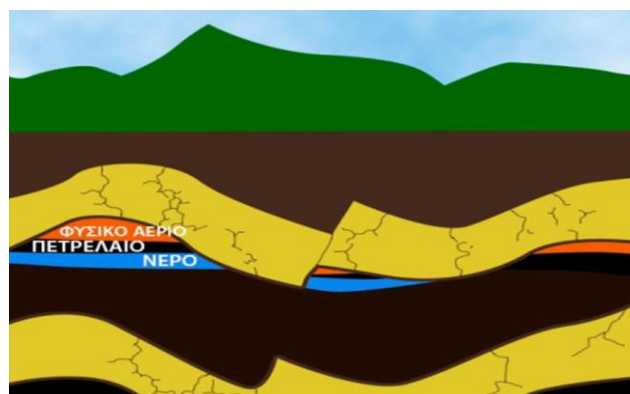
Σχήμα 1.3 Γεωλογικοί σχηματισμοί με πετρέλαιο, φυσικό αέριο και αλμυρό νερό.
