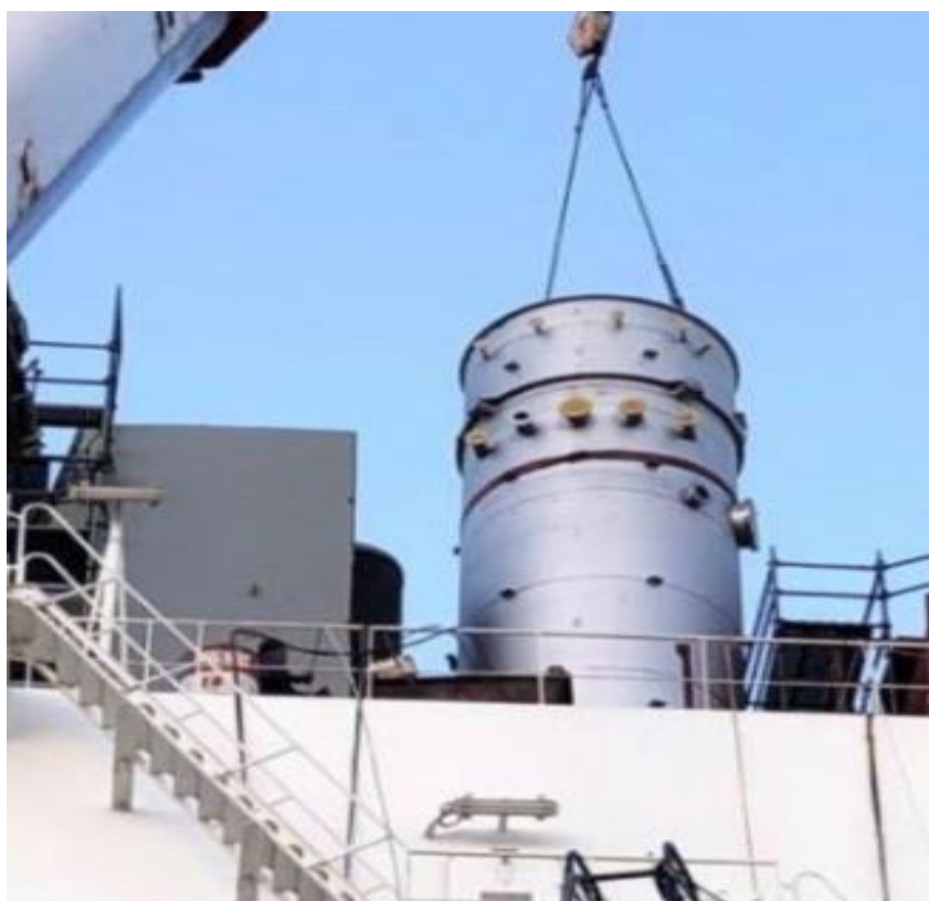
Εικόνα 4.2.1 Πλυντρίδα εγκατεστημένη σε πλοίο.
