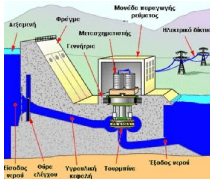
Εικόνα 12: Σχηματική Αναπαράσταση ενός Υδροηλεκτρικού Σταθμού
