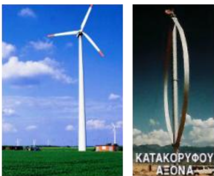
Εικόνα 4: Αιολική μηχανή οριζόντιου (αριστερά) και κατακόρυφου άξονα περιστροφής
