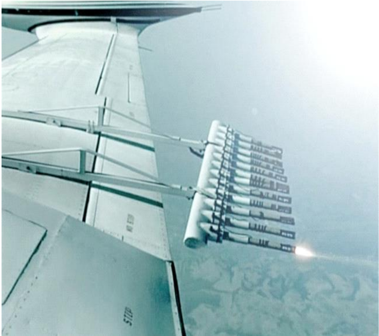
Εικόνα 10 : Παρατηρούμε την μορφή των χημικών που χρησιμοποιούνται για την σπορά σύννεφων όπως και τον τρόπο αυτανάφλεξης πάνω από το αεροπλάνο.
